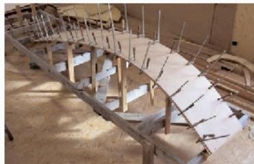
de fond, de bouchain, de flanc et de livet en bois massif. Ce type de structure autorise un réglage progressif à l'aide de presses qui permet de parfaitement contrôler la forme de la coque. C'est un confort appréciable en construction professionnelle et plus encore pour des amateurs. Une fois la charpente réglée, les pièces de liaison sont collées à l'époxy pour rendre l'ensemble homogène et indéformable.
