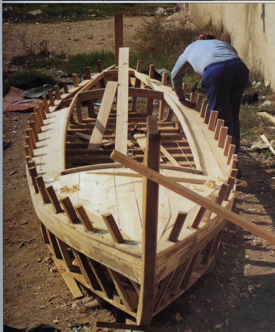
Automne 1996 : sur le port de Catarroja, Vicente (en haut) a mis en chantier une barca de 8 mètres construite sur quille, tandis que Roiget (en bas) s'affaire sur un marimatxo, dont le fond plat, comme celui du barquet, lui confère une grande stabilité, et dont les œuvres mortes, l'étrave courbe et l'étambot vertical rappellent ceux d'une barca.
